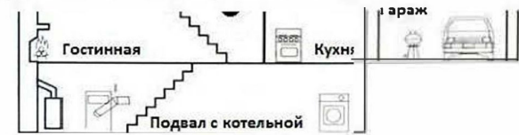
● Основные места установки сигнализаторов газа
