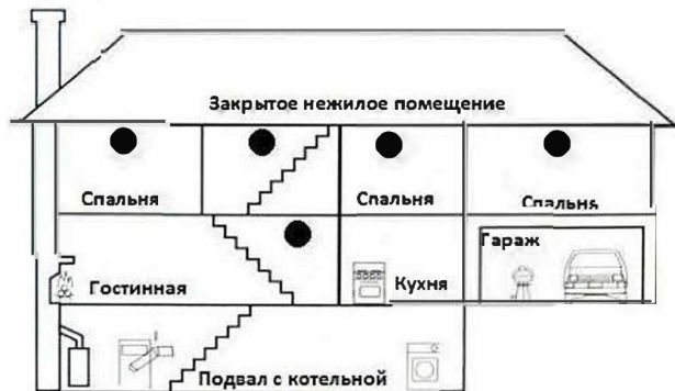
● Основные места установки сигнализаторов газа
