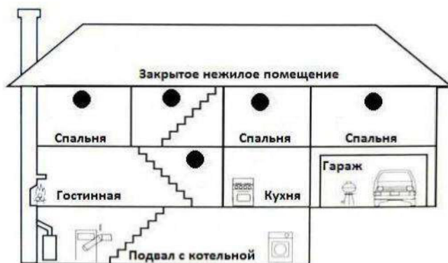
● Основные места установки сигнализаторов газа
